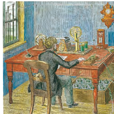
▶4 モールス電信機 1837年、アメリカ人モールスが発明。44年にはワシントンとボルティモア間に世界初の電信線が敷設された。1854年に来日したペリーは将軍にモールス電信機を献上した。
