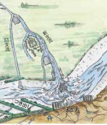
▲1 信玄堤 甲斐国を領した武田信玄が釜無川の氾濫から耕地を守るためにつくらせた堤防。支流を二つに分けて流れをかえ、支流がぶつかる釜無川の本土手に堤防（本土手）を築いた。本土手には竹を植え、さらに本土手の前につき出しという石積みをつくり、本土手を守る工夫をした。
